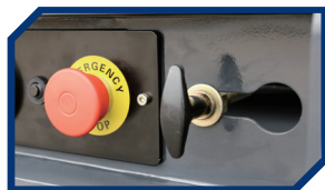
Sistema de Descida de Emergência
